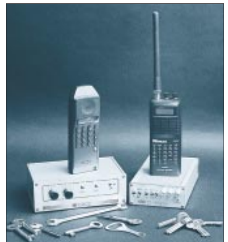
Die richtigen Schlüssel zur Entschleierung – beispielsweise des Schnurlos-Telefons (links) mit seiner Invertierung: Ein Scanner wie der AE39H von Albrecht (rechts) sowie die Dekodierer CDC2 und C1-Digital Foto: wb
