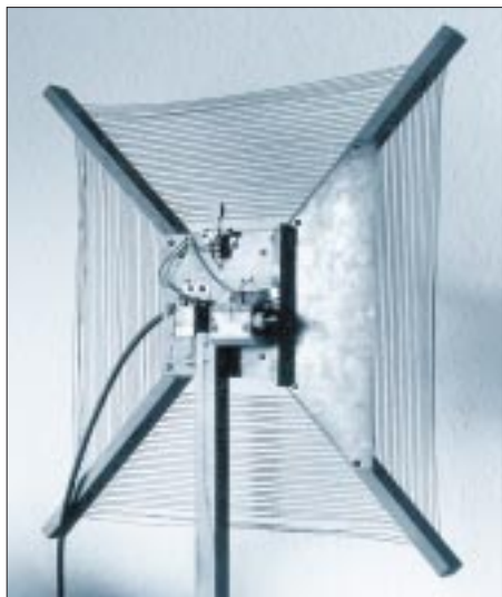
Rahmenantenne für besseren MW-Empfang Fotos: Hans Weber
